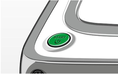
Imagem 3.17 Pressione a tecla Start/Stop do Robô Aspirador para o «Modo stand-by»
